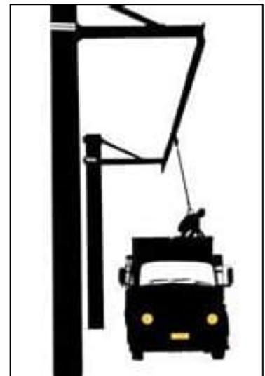
Se houver a necessidade de nivelamento de carga para conferência, os profissionais devem realizar atividade atracados a linha de ancoragem utilizando ferramentas adequadas para a atividade.
