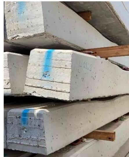
**Figura 6** -Modelo de caibro em utilização INADEQUADA
