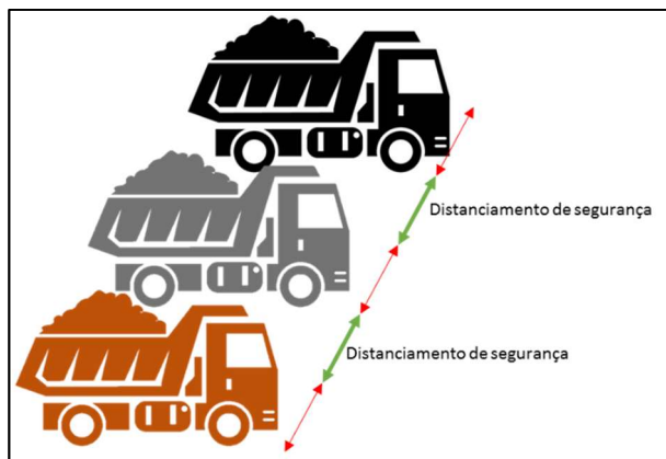
Distanciamento de caminhões para basculamento – Caminhões com inclinômetro
