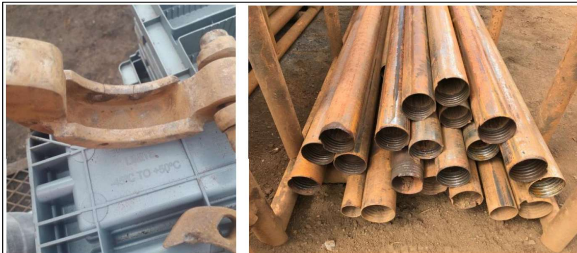
Exemplo de trinca em ferramenta e deformações em hastes
