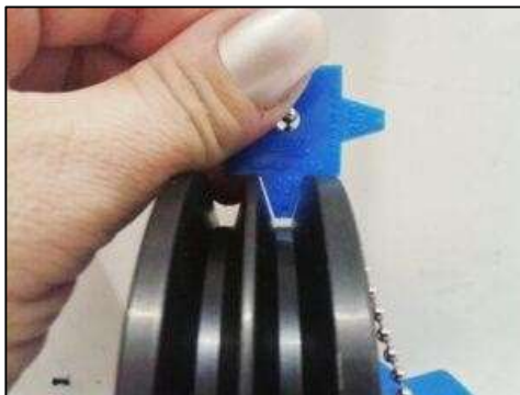
Figura 23 - Exemplo de inspeção do gorne da roldana
