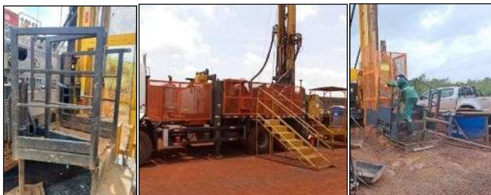
Exemplos de acessos/escadas, plataformas modulares.
