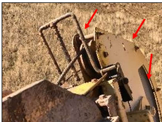
Exemplo de centralizador de cabo de aço do guincho principal na roldana
