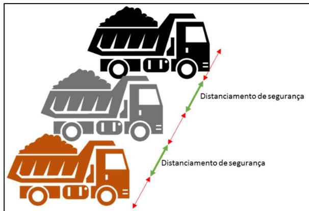
Figura 4 - Distanciamento de caminhões para basculamento – Caminhões com inclinômetro
