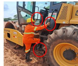
Apoio de três pontos
